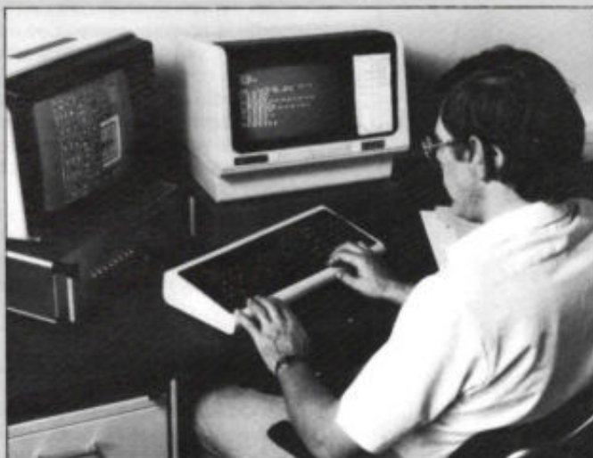
(3). Controleren en eventueel modificeren van het maskerontwerp met behulp van kleurenbeeldscherm.
