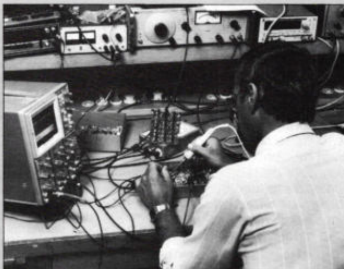
(1). Onderzoek aan een breadboard-schakeling ten behoeve van de ontwikkeling van de in dit artikel vermelde vloeistofdebietmeter.
