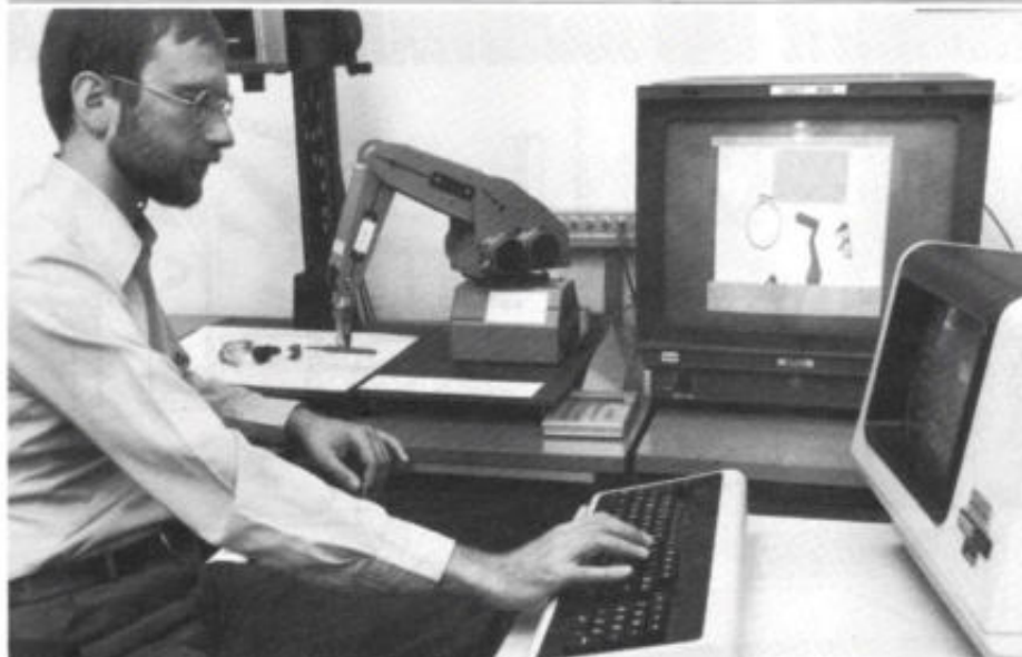
AEG ontwikkelde een beeldverwerkingssysteem waarmee robots onregelmatig gerangschikte voorwerpen kunnen herkennen, oppakken en ergens anders in een gewenste stand neerleggen.
