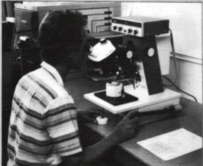
(13). De laatste stap in het fabricageproces is het aanhechten van de verbindingsdraden en het vervolgens afsluiten van de behuizing.
