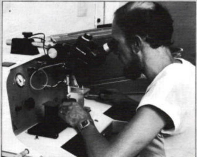
(12). Na het verzagen van de plak, wordt elk „goed” bevonden IC-kristal zorgvuldig in een behuizing gehecht.
