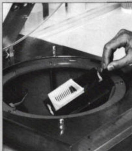
(9). Na een reinigingsbewerking volgt het drogen van de siliciumplakken in een centrifuge.
