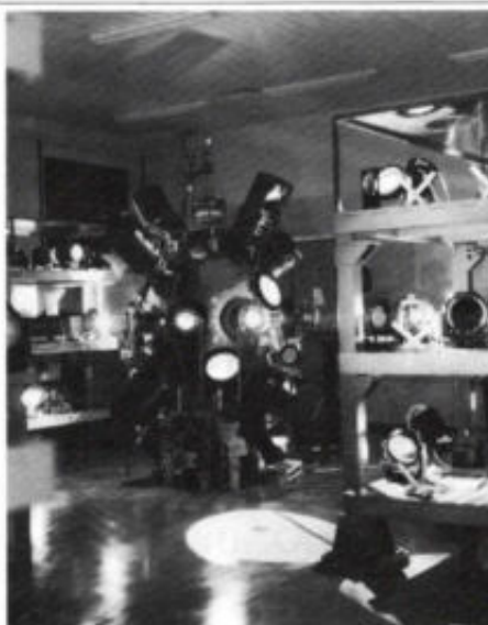
Bolvormige twaalfpoorts vacuümkamer in het Rutherford Appleton Laboratorium, waarin röntgenstraling-emitterende plasma's worden opgewekt.
