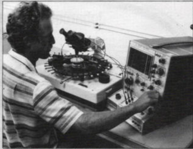
(11). Na de visuele inspectie volgt het parametrisch beproeven van de schakelingen op een „puntenprikkers” die is verbonden met een karakteristiekenschrijver.
